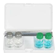
**Oil Test** - тест для определения типа масла.
